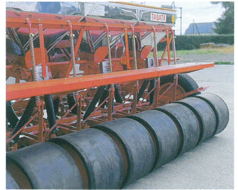
湿った時でも土が付着しにくく 鎮圧効果が生きるゴムローラー
