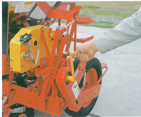
ハンドル回転による計量 無段変速装置 (右肥料) 無段変速装置 (左種子)
