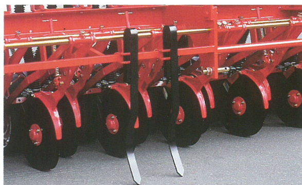
▲トラクターの踏圧によるわだちを効率よく除去するタイヤ消し（オプション）
