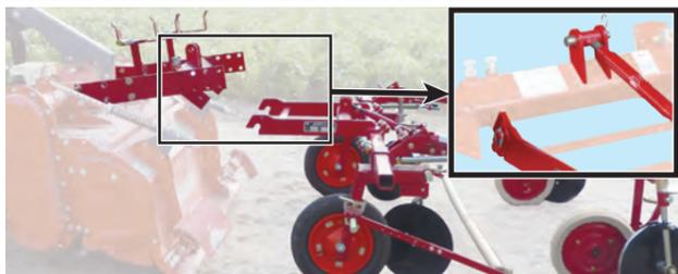
ロータリーハロー取付部とマルチャー本体部が着脱式で、簡単にマルチャー本体部を外せます。ロータリー耕だけをするときに、邪魔となるNMR-1800を外して軽くできます。
