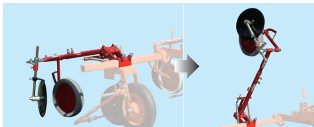
ロータリーハロー装着タイプNMR-1800は、全長が長くなっていますが、サイドビームが跳ね上げ式のため、簡単に全長を短くでき、狭い場所での旋回、移動も簡単に行えます。
