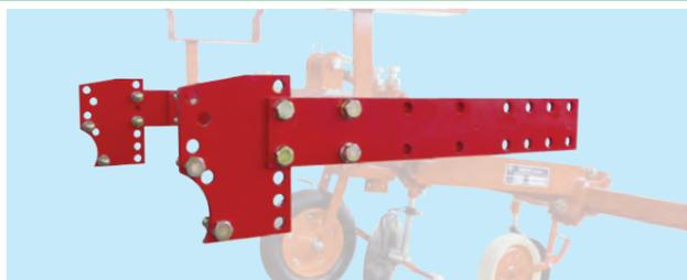
さまざまなメーカーや大きさがあるロータリーハローに取り付けるため、あらかじめ多くの取付穴を設け、使用型式に合わせて最適な位置関係で取り付けができます。しかも、マルチャー本体をオフセットして取り付けすることもできます。
