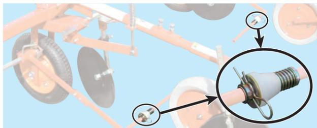
フィルムをたるみなく、まくれづらく強く張りたいときは、フィルム取付アームに付いているフィルムホルダーのピン取付位置を変更してください。フィルムの回転速度が遅くなり、強く張れるようになります。
