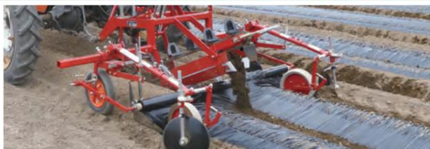
2本の畦に同時にフィルムを張るときや、幅の広いフィルムを張るときに、土のせ装置がフィルム中央に土を落とし、フィルム中央が浮かされるのを防ぎます。しかも、駆動輪に連動した土の繰り出しで、作業速度に合わせて一定量の土を安定して落としていきます。
