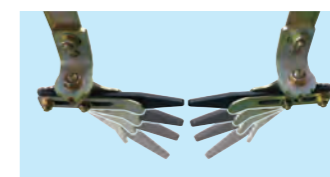
「K Yブレードゴム取付金具」を固定しているナット1個を緩めれば、作用角度を自由自在に調整できます。
