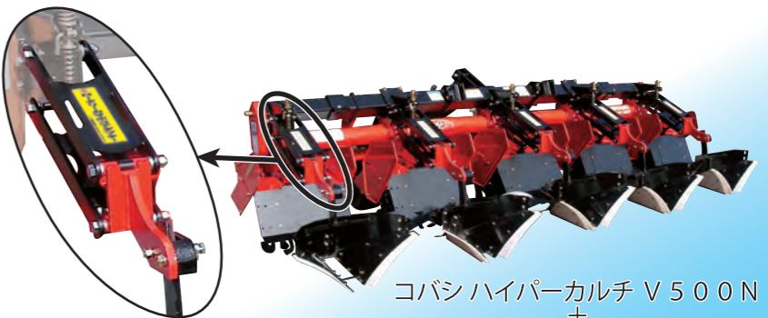
コバシ製ロータリーカルチ「ハイパーカルチ」に専用アダプターを取り付けるだけで、カマボコ培土器シリーズ(KR-725・SKR-75)を使用でき、土塊の少ないロータリー培土ができます。
