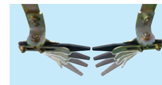
「K Yブレードゴム取付金具」を固定しているナット1個を緩めれば、作用角度を自由自在に調整できます。
