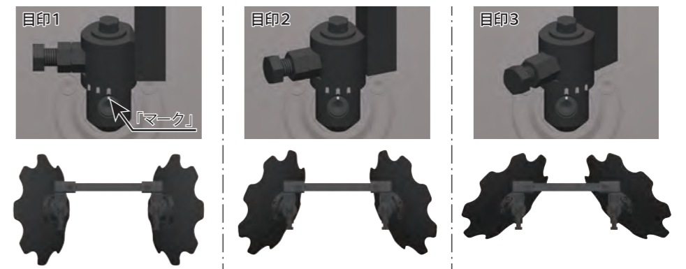
「かどまるディスクブラケット」の「かどまるディスクシステム」取付部外側、取り付け位置が皿モミ「中」のときに2・2.5°ピッチで角度変更
