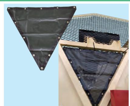
タンク前側の網にぶつかって飛散するビートの破片や汁が、トラクターのリアウインドウを汚して視界を悪くするのを防ぐので、リアウインドウからの視界は常に良好!! しかも、付属のケーブルタイで固定するだけで簡単に取り付けができます。
