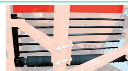
高速回転のローラーと「パフォーマンスロッド・ドロッド付第2コンベヤ」とのコンビネーションで、強制的に土砂分離・茎葉処理を行い、重粘土地帯でより一層の能力を発揮します。また、ローラーにはゴムを焼き付けているので、ビートへのいたわりもバツチです。
