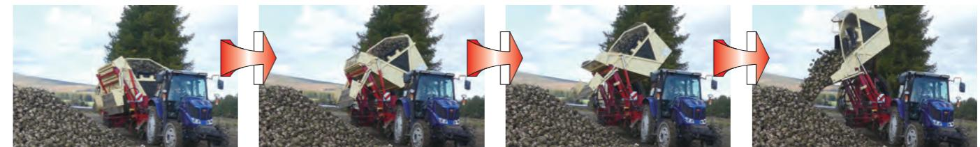
土場にビートを荷降ろしするときの落差を軽減し、ビートへのショックをやわらげつつ、高い山を形成します。しかも、ゴムを多用した本格派仕様です。そのうえ、タンクとの“連動”⇒“固定”的り替えは、レバー操作で簡単に行えます。
