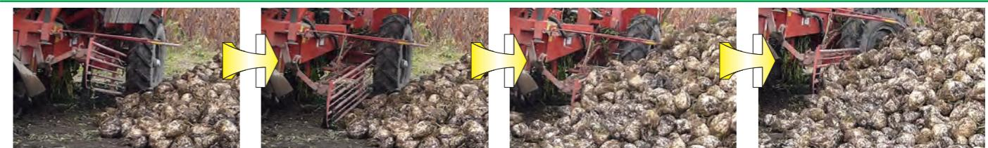
タンクを上げると下がり、下げるとき上昇…、シンプルですが画期的なアイテムです。非常に丈夫ですが、土場に降ろしたビートを踏まないようにやさしくいたわります。しかも、ガード本体はハーベスターより外に出ないので、タンクに連動のままでもダンプ受けができますが、ピンの差し替えで簡単に“連動”⇒“固定”的り替えが行えます。さらに、ガード本体は、前方の開閉のほか、水平にも開閉できるので、掘取口周辺のグリースアップやロッドチェーンの張り調整、掃除の際に邪魔になりません。
