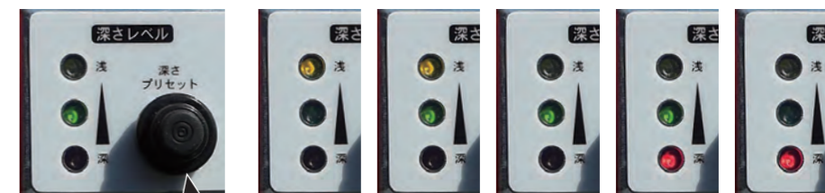
『深さプリセット』ボタン 基準の深さを簡単に設定変更できます
