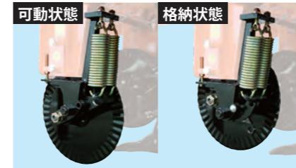
計算し尽くされた2本のバネとリンク機構で、どんなに硬い畑でもしっかりと土を切り、石がある場合のみ、衝撃から逃げてコルターを護ります。また、端の1本を収穫するときは、ロックボルトを緩めることなく、ピン1本を差し替えるだけで、簡単にコルターを可動状態から格納状態に切り替えることができます。
