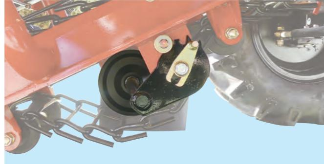
大きなローラーが、ロッドチェーンの中央部で最適なテンション効果を発揮します。テンション位置の変更方法は、支点ボルトを緩めてテンション止め金具をズラすだけです。飲み込み性能を悪くするロッドチェーンの緩みを、簡単に調整できます。
